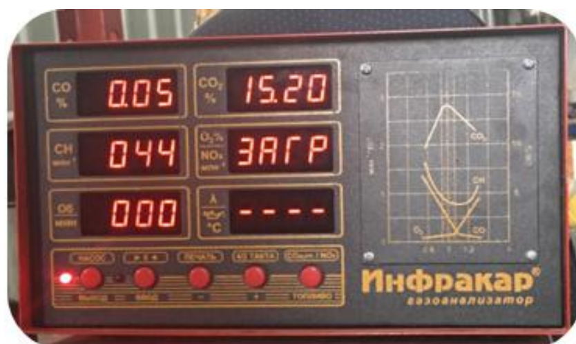
Рисунок 3.13 - Обнаружения выхлопа без ВГ
