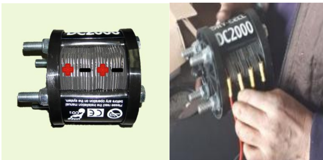
Рисунок 3.8.2 - Электрическое соединение контактов ННО.
