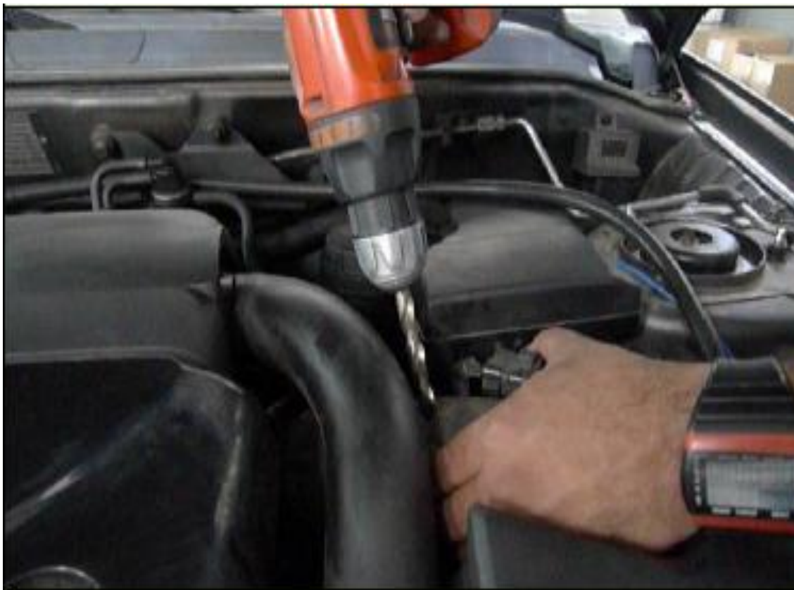
Рисунок 3.6 - Просверлите отверстие 8 мм близко к впускному коллектору
