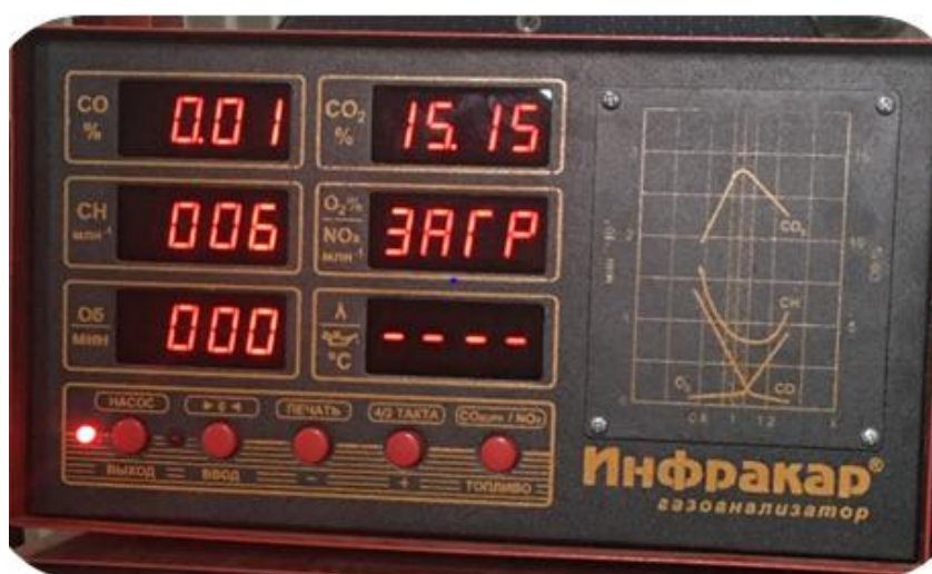
Рисунок 3.14 - Обнаружения выхлопа с ВГ
