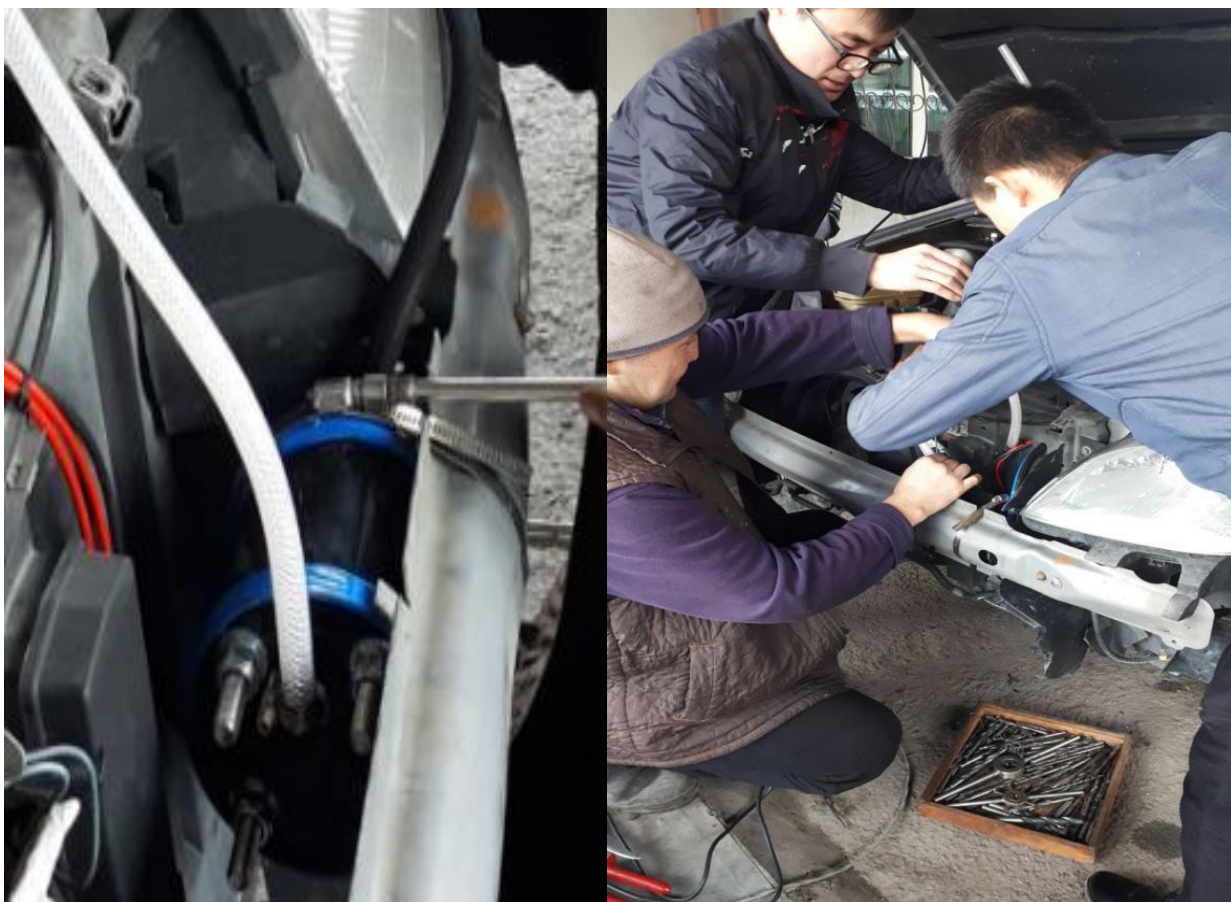
Рисунок 3.3 - Установка ННО на автомобиле Ситроен 5
